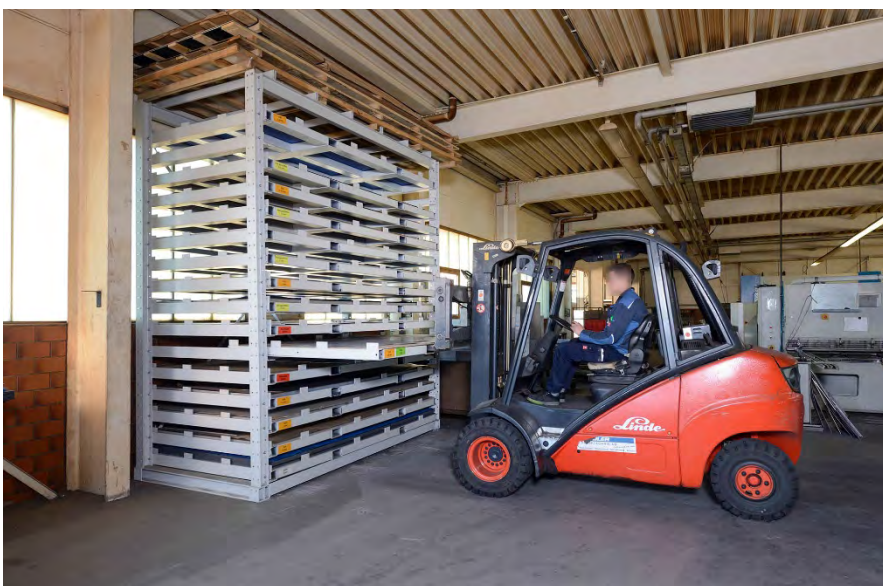
Blechzugregal zur Beladung mit dem Stapler.
